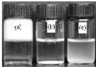
图 6 PTFE 微粉在水中(a)、 G=15.4\% 的 PTFE 微粉在水中(b) 和氢氧化钠溶液中(c)的分散行为
