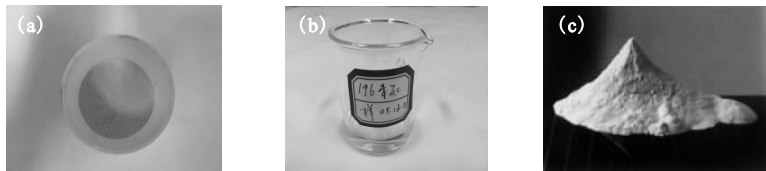
(a)——黄色粉末状未知物质,(b)——未知物质溶于硝酸溶液,(c)——重铀酸铵
