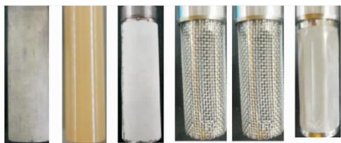
图 6 六种不同类型的阳极套管示意图<sup>[66]</sup>
