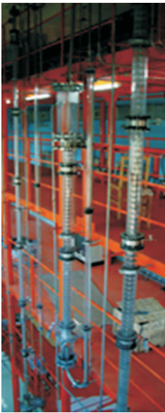
图 8 从生产堆高放废液中萃取分离 Cs 的设备流程示意图和台架
