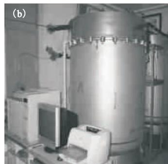
图 10 中国 8  $m^3/d$ (a)、50  $m^3/d$ (b) 色谱分离氢同位素系统
