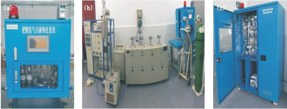
(a)——钍膜分离器,(b)——固定床反应器,(c)——钍膜反应器
