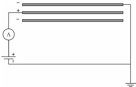
图 2 流气式电离室的输出回路 Fig. 2 Output circuit of flow gas ionization chamber
