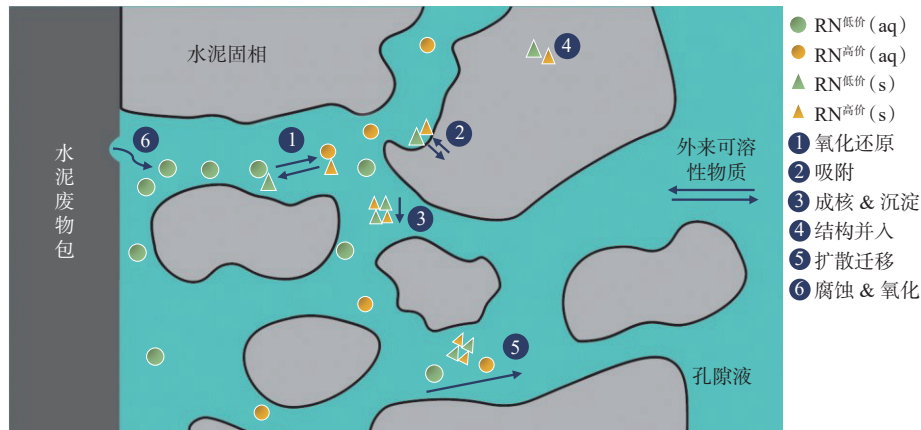
图 2 放射性核素(RN)在水泥孔隙介质中吸附扩散过程示意图
