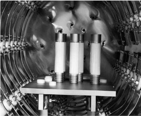
图 5 中子管高温排气炉中的布局
