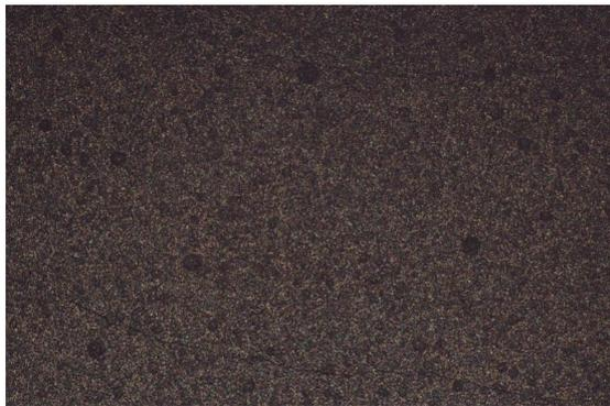
图 3 脉冲电镀法制备的厚铑靶( $\times$ 200)
