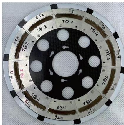
图2 大尺寸<sup>243</sup>Am扇形靶组成的转轮靶实物照片
