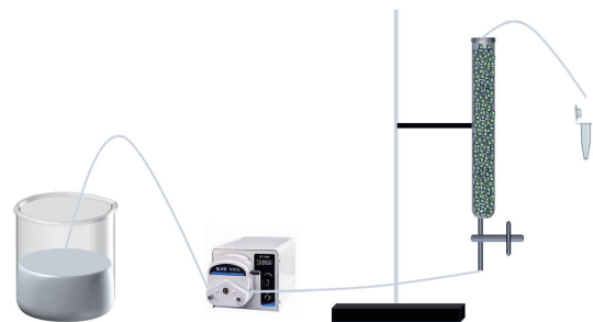
图1 Cs + 动态吸附实验装置图
