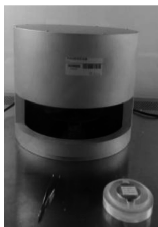
图1 241 Am \alpha 粒子辐射源装置图
