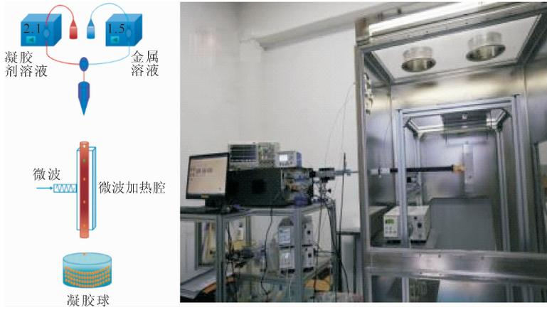
图 10 无冷却即时混合-微波加热快速溶胶凝胶工艺示意图(a)以及手套箱实验平台(b)<sup>[47]</sup>
