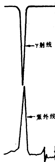
图4: ^{99}\text{Tc} 和 ^{99\text{m}}\text{Tc} -BAT-PDA的HPLC图 HPLC条件: PRP-1反相柱(4.1mm×250mm); 流速: 1.0ml/min; 流动相: 乙腈/3,3-二甲基戊二酸 (0.01mol/l, pH=3.0)为85/15,
