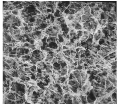
图 3 100 K/min 退火制备泡沫的结构形态
